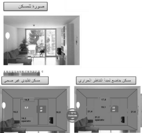
شکل (11) يبين الفرق بين مبنى مستدام وأخر تقليدي مرتبط بالتناظر الحراري (15)
